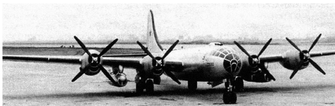
Самолет-носитель Ту-4К с двумя ракетами КС-1
