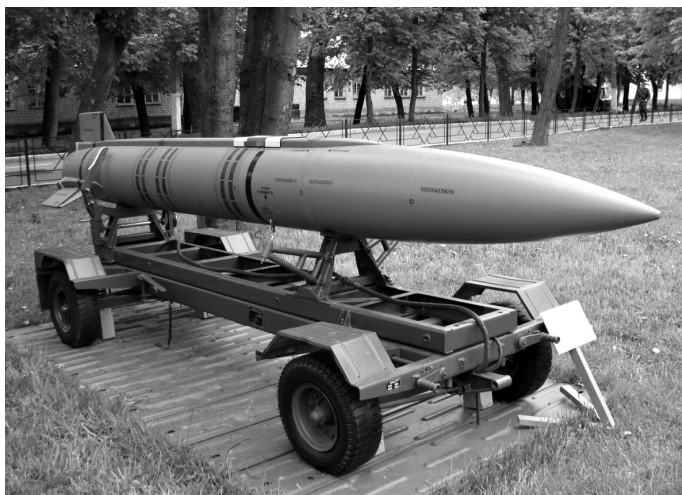
Ракета Х-15 имеет бескрылую схему с консольным цельноповоротным оперением
