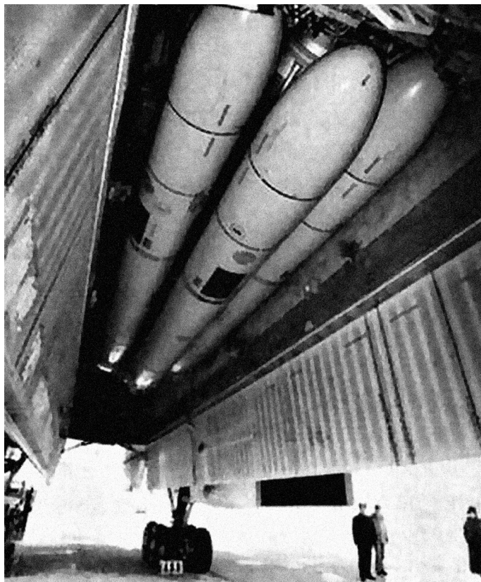
Подвеска шести ракет Х-55 в грузовой отсек самолета-носителя
