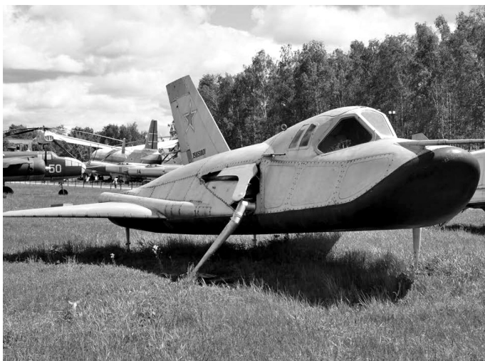
Дозвуковой аналог многоэтажного космического ракетоплана системы «Спираль», построенный в Дубне (Центральный музей Военно-воздушных сил в Монино)
