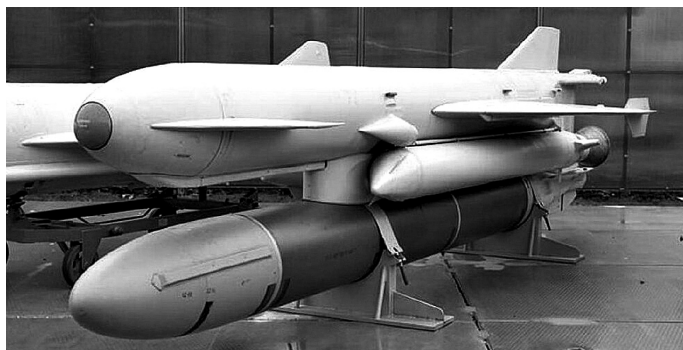
Ракета 85-ПУ с подвешенной гондолой, в которой размещены торпеда и дополнительная БЧ
